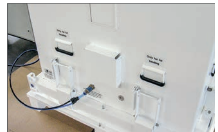
Wasserdampfdichter Behälter bei Dichtheitsprüfung durch Überdruck
