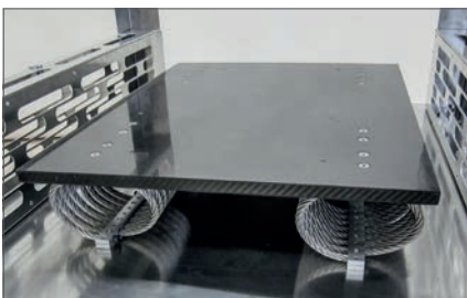
Aufnahmetisch, schwingend gelagert mit Gummipuffer oder Drahtseildämpfer
